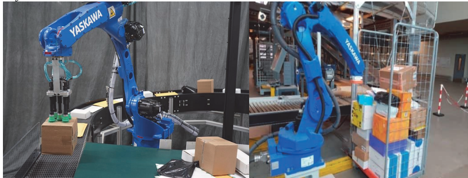
Slika 1. Manipulativni robot Yaskawa GP12 u radu [12]
