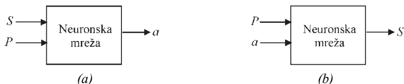
Slika 2. Predloženi opšti model za određivanje inverzne vrednosti Erlang B formule: (a) određivanje vrednosti saobraćaja, (b) određivanje broja kanala
