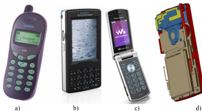
Slika 2 – a) Monoblok mobilnog telefona, b) Ugrađena PIF antena u monoblok, c) Mobilni telefon sa preklopom d) ugrađena PIF antena u deo telefona sa preklopom [4]
