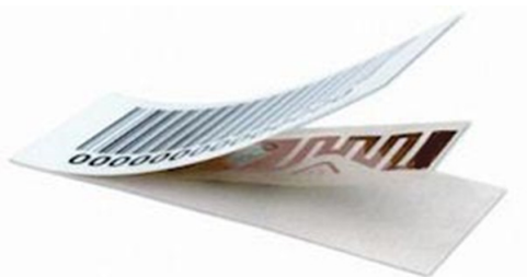
Slika 1. Troslojna struktura RFID Poštanske marke
