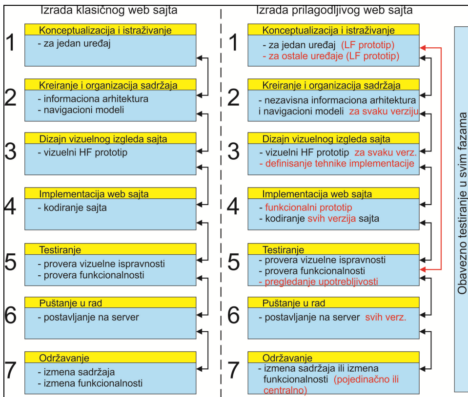
Slika 3. Uporedni dijagram sa fazama izrade klasičnog i prilagodljivog web sajta
