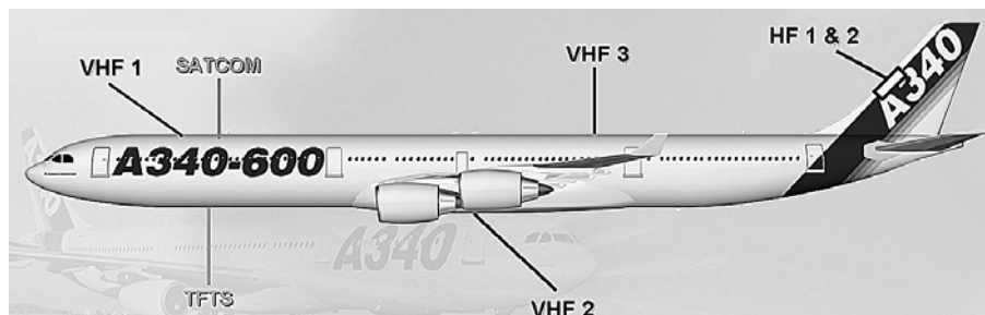
Slika 2. Položaj komunikacionih antena na avionu Airbus A340-600
